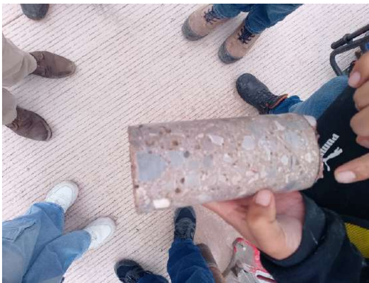
Núcleo para realizar pruebas de espesor y resistencia del concreto
